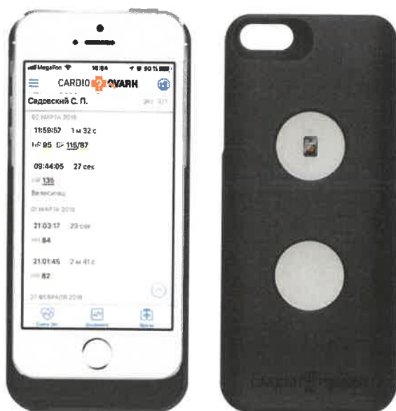
Рис. 1 Общий вид электрокардиографа CardioQVARK
